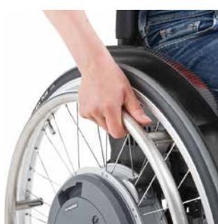
Het gebruik van de hoepel activeert de **e-motion** hulpmotoren. / Les moteurs d'assistance de l'**e-motion** s'activent après l'utilisation des cerceaux.
