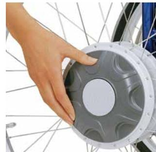
Het ontkoppelen van de hulpmotor maakt hoepelen met de hand mogelijk. / *Le démontage du moteur d'assistance offre la possibilité d'obtenir une chaise manuelle.*
