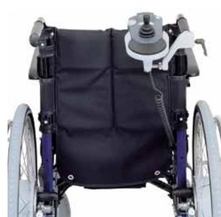
Begeleidersbediening kan links of rechts op het duwhandvat gemonterd worden. / Commande d'assistant peut être montée à gauche ou à droite de la poignée de poussée.
