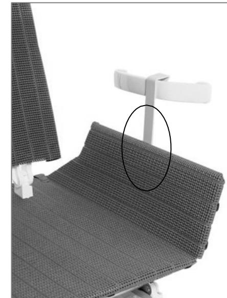
Der Seitenklappenabweiser ist an der Stelle des Handgriffs zu montieren, die am weitesten in die Wanne hineinragt. Er verhindert eine Kollision der Seitenklappe mit dem Handgriff während der Auffahrt.
