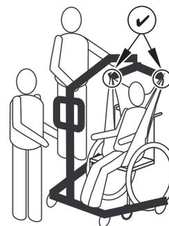
Levez la flèche jusqu'à ce qu'il y ait une tension sur les bandes de la sangle et assurez-vous que la sangle est correctement fixée aux crochets du fléau. Reportez-vous à la section 6.2.1 Installation de la sangle sur le lève-personne, à la page 22. Si l'une des attaches n'est pas correctement installée, redescendez le patient sur le fauteuil roulant et corrigez le problème.
