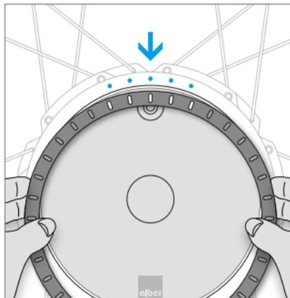
Alignez la nouvelle bague à appliquer de façon à ce que les cinq évidements pour LED s'adaptent sur les cinq LED de l'entraînement.
