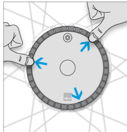
Steek de pennen aan de onderkant van de ring in de hiervoor bedoelde openingen en klik de drie sluitingen vast.
