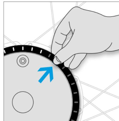
Saisissez le bord de la bague et enfoncez l'ongle du pouce dans l'encoche. Tirez simultanément vers l'extérieur.
