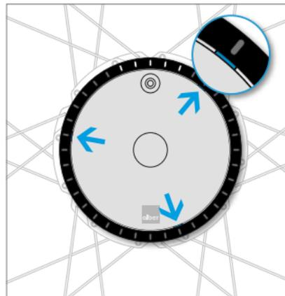
Localisez une des trois encoches situées sur le bord extérieur du cache (entre la bague et le cache).
