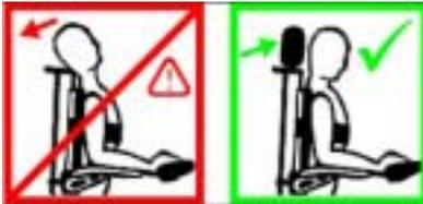
**Dieser Rollstuhl darf als Fahrzeugsitz verwendet werden, jedoch nur wenn er mit einer für diesen Rollstuhl von Invacare freigegebenen Kopfstütze ausgestattet ist!**
