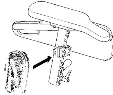
Der Adapter lässt sich in 90°-Schritten drehen. Dadurch haben Sie vier Einschubrichtungen zur Auswahl. Sehen Sie die Installationsanleitung, die Sie bei Ihrem Invacare®-Fachhändler oder direkt bei Invacare® erhalten.
