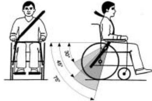
Der Beckengurt sollte ungehindert und nicht zu locker im Bereich zwischen Becken und Oberschenkel des Benutzers anliegen. Der optimale Winkel des Beckengurtes zur Horizontale liegt zwischen  $45^\circ$  und  $75^\circ$ . Der maximale Winkelbereich liegt zwischen  $30^\circ$  und  $75^\circ$ . Auf keinen Fall darf der Winkel  $30^\circ$  unterschreiten!
