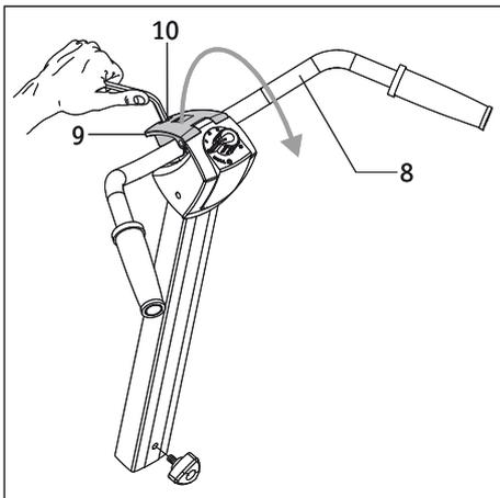
Ist die Verstellmöglichkeit nicht ausreichend tief, kann der Lenker [8] vollständig entnommen und um 180 Grad verdreht wieder eingebaut werden. Hierdurch ergibt sich eine vertiefte Bedienposition.
