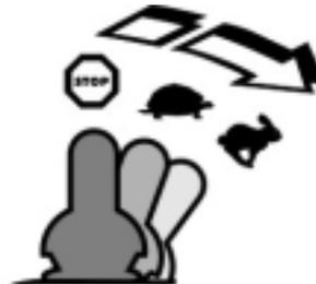
**Je weiter der Joystick in eine bestimmte Richtung bewegt wird, desto dynamischer reagiert der Rollstuhl.**
