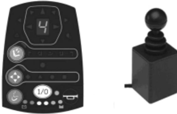
Zusätzlich zum Joystick können optional bis zu drei Buddy-Buttons für die Steuerung und für Schaltfunktionen verwendet werden. Durch die wählbare Position der Buttons können Sie diese individuell auf Ihre Bedürfnisse anpassen und einstellen, um den Rollstuhl zu steuern.
